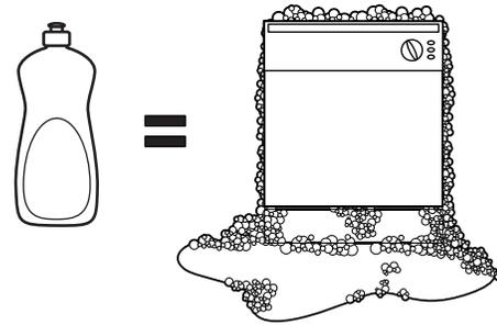
**NOTE :** L'utilisation d'un détergent qui n'est pas conçu spécialement pour un lave-vaisselle peut occasionner un excès de mousse dans le lave-vaisselle. Pendant le fonctionnement, cette mousse déborde et couvre le plancher de la cuisine en le mouillant.
