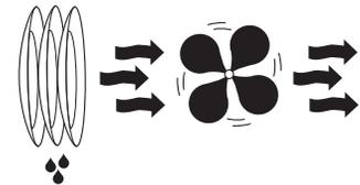
Si vous avez choisi l'option de **SÉCHAGE À CHAUD**, le ventilateur de séchage fonctionne pendant la partie de séchage du cycle et jusqu'à 2 heures après que le voyant **PROPRE** soit allumé, selon le cycle de lavage choisi. Si vous n'avez pas choisi l'option de **SÉCHAGE À CHAUD**, le voyant **PROPRE** s'allume à la fin du rinçage final et le ventilateur fonctionne jusqu'à 4 heures selon le cycle de lavage choisi.
