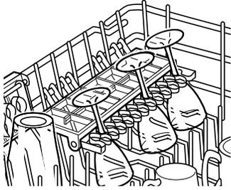
Ce panier peut être placé en position haute ou basse pour faciliter le rangement. Un porteur de verres à vin (sur certains modèles) tient les verres à vin pour un bon lavage.
