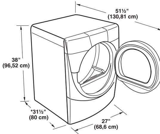
\*La plupart des installations requièrent un espace minimum de 5 1/2" (14 cm) derrière la sècheuse pour le conduit d'évacuation avec coude. Voir "Exigences concernant l'évacuation".
