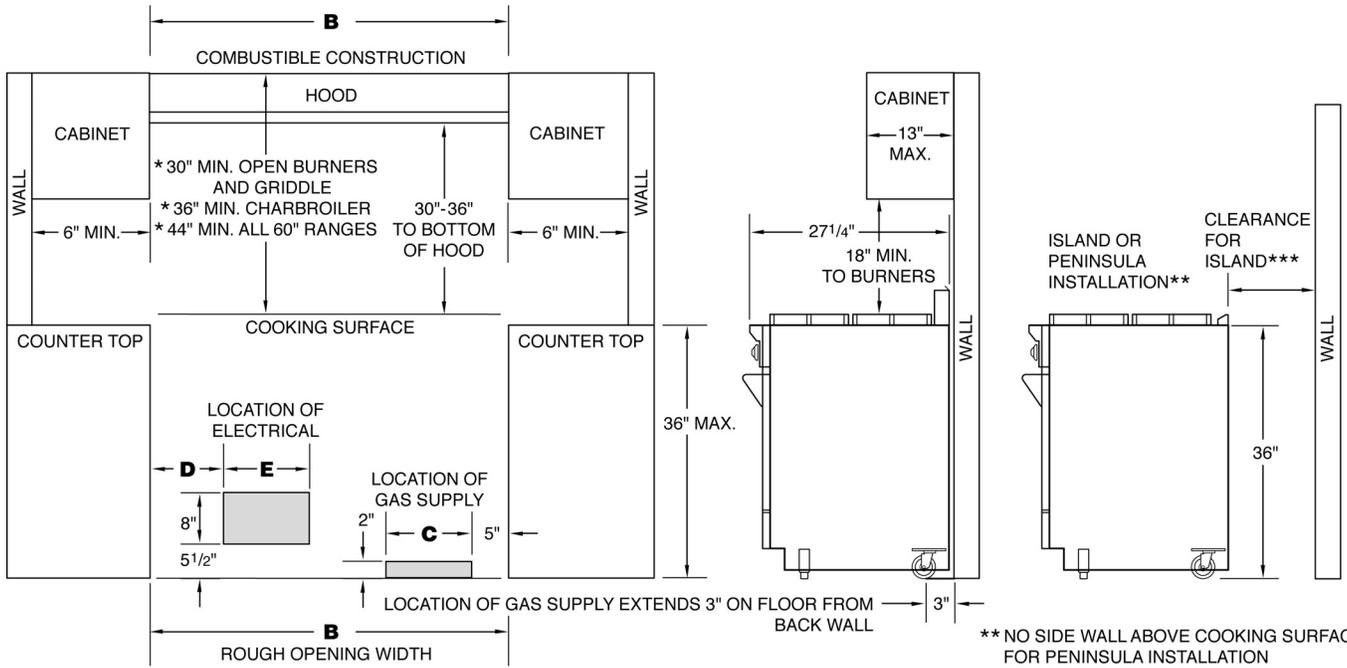
\* MINIMUM DISTANCE FROM COOKING SURFACE TO BOTTOM OF COMBUSTIBLE CABINET
