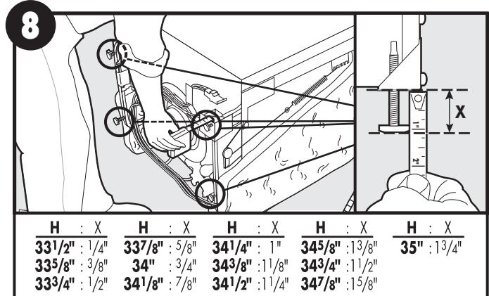
X= Adjusted Foot Height / Altura Ajustada de la Pata / Réglage de la hauteur du pied
