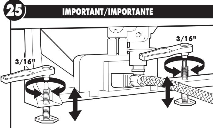
If not level repeat 24/Si no está nivelado, repita el paso 24./ En cas de non-nivellement, voir l'étape 24
