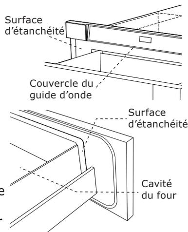
2. Retirer l'étiquette des caractéristiques, s'il y en a une. Vérifier que le four n'a aucun dommage, comme un tiroir mal aligné ou plié, des joints ou des surfaces d'étanchéité de porte endommagés, des glissières cassés ou lâches et des bosses à l'intérieur de la cavité ou sur la façade du tiroir. En cas de dommages, ne pas faire fonctionner le Microwave In-A-Drawer™ et contacter votre détaillant ou un RÉPARATEUR AUTORISÉ DACOR.
