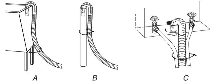
Si les robinets d'eau et le tuyau rigide de rejet à l'égout sont placés en retrait (voir illustration C), introduire l'extrémité en col de cygne du tuyau de vidange dans le tuyau rigide de rejet à l'égout. Attacher fermement les tuyaux d'arrivée d'eau et le tuyau de vidange ensemble, avec la courroie perlée.
