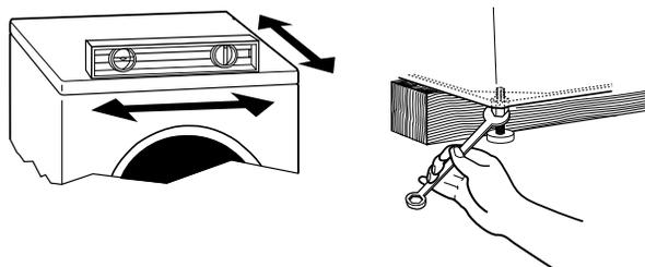
Si la laveuse est placée contre un mur, on doit l'écartier légèrement du mur avant de l'incliner vers l'arrière. Si la laveuse n'est pas d'aplomb, soulever l'avant de la laveuse avec une cale de bois et ajuster la position des pieds selon le besoin; soulever ensuite l'arrière de la laveuse et ajuster la longueur des pieds selon le besoin. Répéter ces opérations jusqu'à l'obtention d'un aplomb correct de la laveuse.
