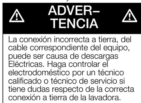
No modifique el enchufe provisto con el electrodoméstico. En caso que no pueda conectarlo al tomacorrientes, haga colocar un tomacorrientes apropiado por un electricista calificado.
