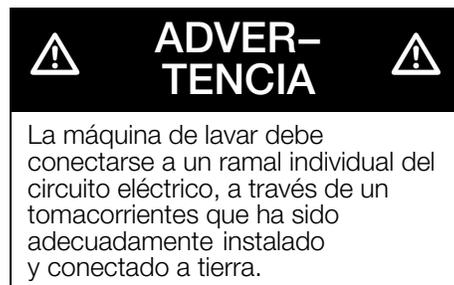
El voltaje de la instalación domiciliaria, debe coincidir con el voltaje especificado de la máquina de lavar (ver la chapa de características en página 100).
