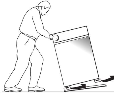
TILT THE DRYER SIDEWAYS AND REMOVE THE FOAM SHIPPING PADS BY PULLING AT THE SIDES AND BREAKING THEM AWAY FROM THE DRYER LEGS. BE SURE TO REMOVE ALL OF THE FOAM PIECES AROUND THE LEGS.
