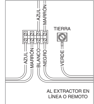
Cableado del extractor en línea | remoto.
