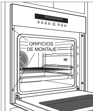
Instalación del horno.
