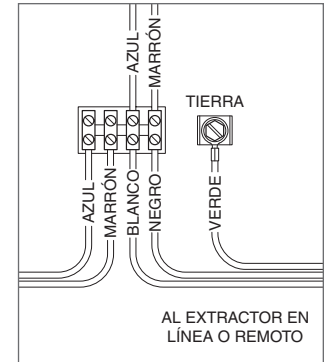
Cableado del extractor en línea | remoto.
