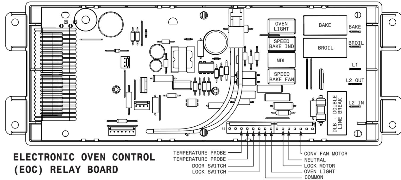
**ELECTRONIC OVEN CONTROL (EOC) RELAY BOARD**
