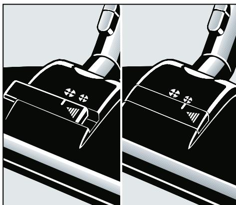
En todos los demás casos, la válvula reguladora de potencia debe mantenerse cerrada para que actúe toda la potencia de aspiración del aparato sobre el suelo.
